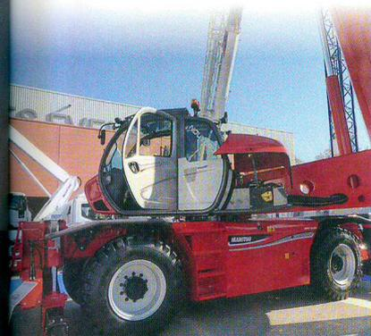
Manitou hat einen neuen drehbaren Teleskoplader mit 32 Meter Hubhöhe enthüllt. Der neue Roto trägt die Typenbezeichnung MRT 3255, kann bis zu 5,5 Tonnen heben und erreicht eine Hubhöhe von 31,6 Meter. Unter der Motorhaube steckt ein Mercedes Tier IV Dieselmotor in Verbindung mit einem stufenlosen Getriebe von Dana. Von der Steuerung über die Abstützung bis hin zur Kabine weist der MRT 3255 allerhand Neuerungen auf, so der Hersteller.
